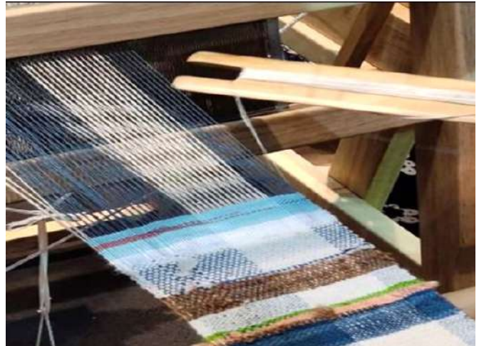
เส้นใยเชิงประกอบนำไปทอเป็นผืนผ้าร่วมกับเส้นใยธรรมชาติ
