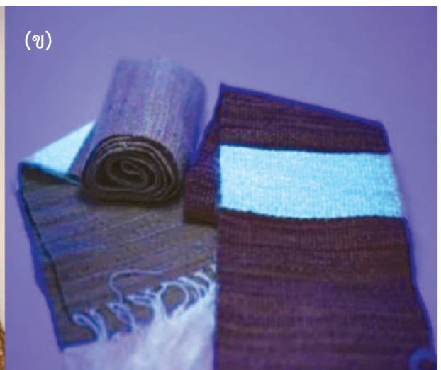
ผลิตภัณฑ์สิ่งทอเชิงประกอบสองฟังก์ชันที่สามารถเรืองแสงและต้านจุลชีพ (ก) ก่อน และ (ข) หลังปิดไฟ
