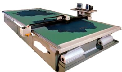
เครื่องตัดหนังอัจฉริยะ เป็นระบบต้นแบบของระบบตัดแผ่นหนังอัตโนมัติ ด้วยชุดควบคุมซีเอ็นซี และระบบกล้องถ่ายภาพแผ่นหนังสำหรับผู้ประกอบการในอุตสาหกรรมเครื่องหนัง
